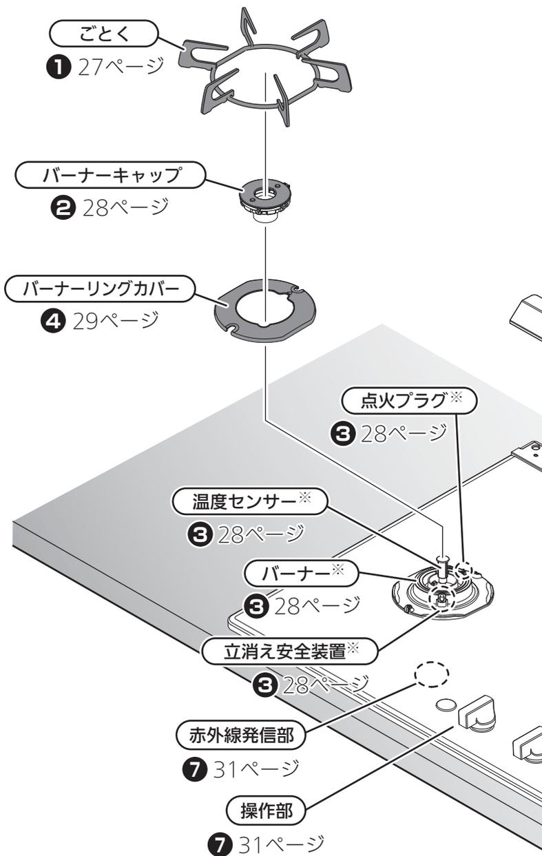
※バーナー、温度センサー、点火プラグ、立消え安全装置は、すべてのコンロバーナーに付いています。
