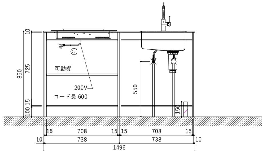
天板開口寸法図 開口：Dタイプ
