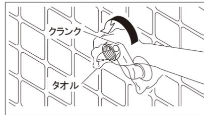
安全のため、固定されているクランクにタオルをあて、両手で左にゆっくりまわして取外します。
