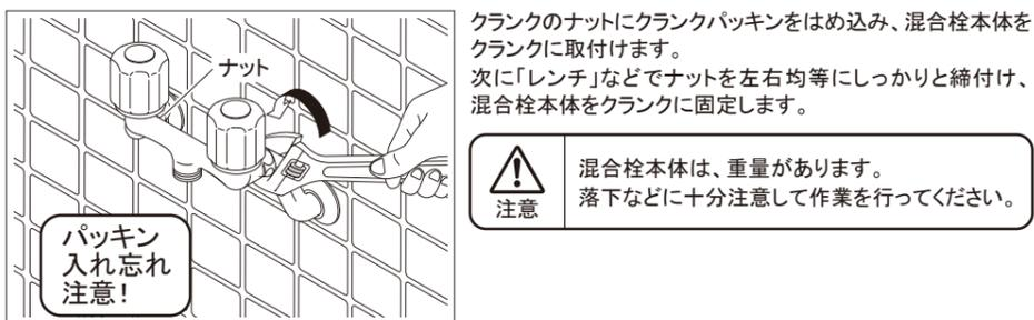
クランクのナットにクランクパッキンをはめ込み、混合栓本体をクランクに取付けます。次に「レンチ」などでナットを左右均等にしっかりと締付け、混合栓本体をクランクに固定します。
